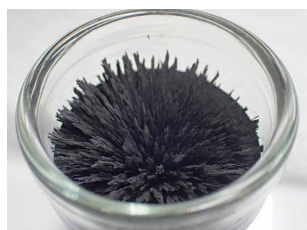
磁铁接近MR流体的状态
