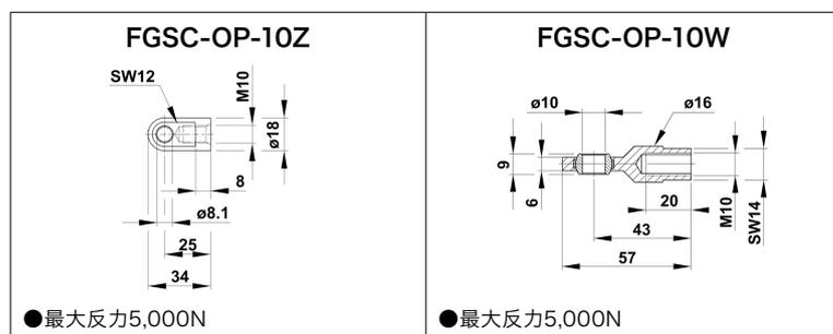
注) 请勿对零件施加最大反力以上的负荷。
