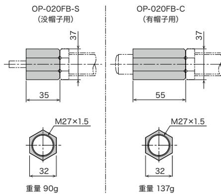
注) 安装时请注意，没有倒角的那一面为冲突面。
