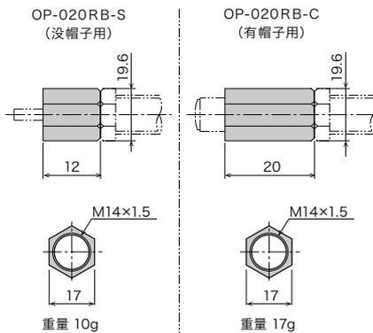
注) 安装时请注意，没有倒角的那一面为冲突面。
